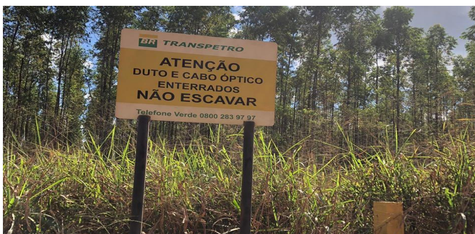
Figura 9 – Placa informativa da estrutura.
