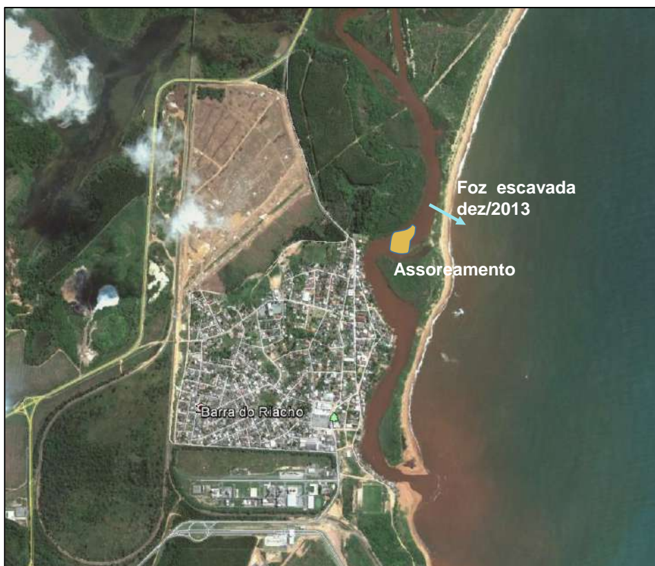
Figura 9-114: Foz escavada em situação de emergência (seta azul) e assoreamento no Rio Riacho (em amarelo).
